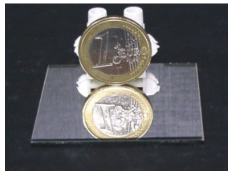
Abb. 3: Hochreflektierende Silberschicht für optische Anwendungen
