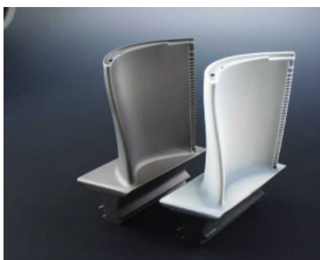
Abb. 2: Keramische Wärmedämmschicht aus Zirkondioxid (weiß) für Gasturbinenschaufeln
